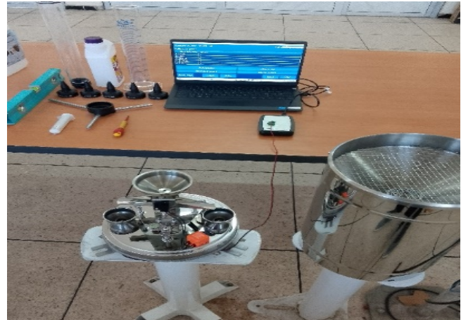
FIGURE 3. Banc d'étalonnage avec équipement pluviométrique
