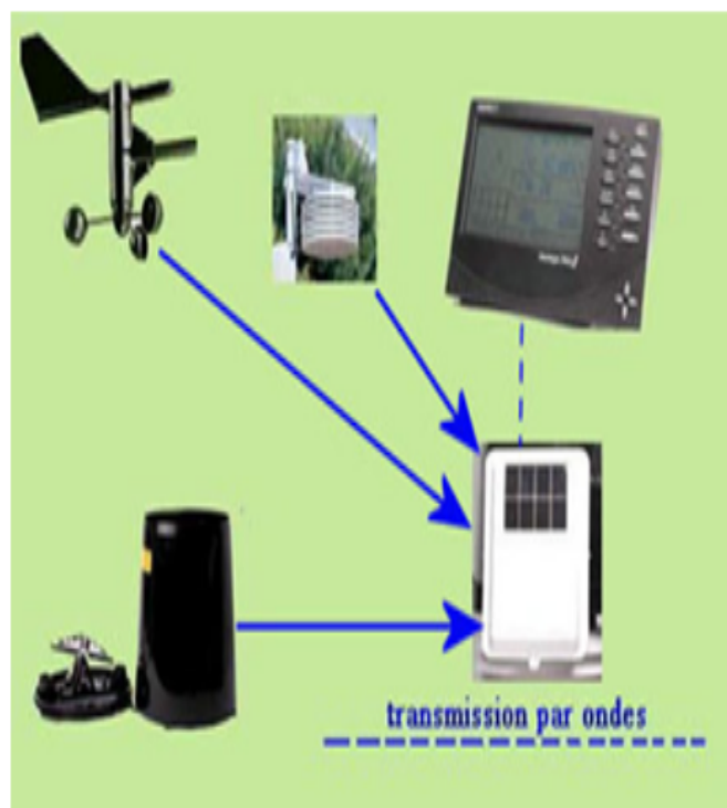
Figure 2. Schéma conceptuel d'une station météorologique
