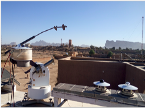
Figure 2. dispositif de mesure du rayonnement à Tamanrasset
