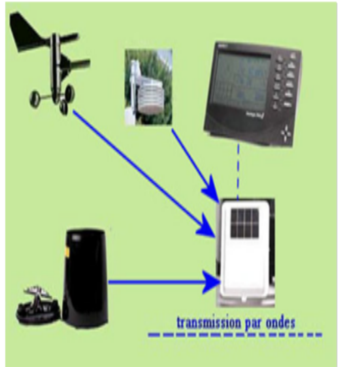
Figure 2. Schéma conceptuel d'une station météorologique
