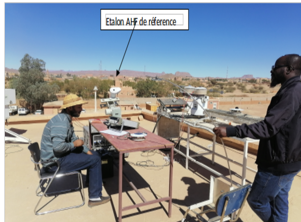
Figure 4. Dispositif d'étalonnage à Tamanrasset
