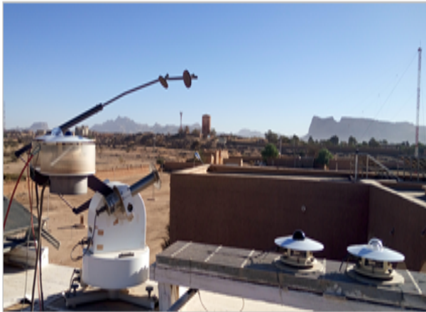
Figure 2. dispositif de mesure du rayonnement à Tamanrasset
